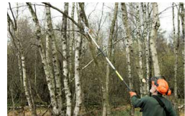
Zum ersten Mal im Einsatz: unsere Teleskopkettensäge bei der Freistellung einer Fahrschneise für den Bagger im Großen Moor
