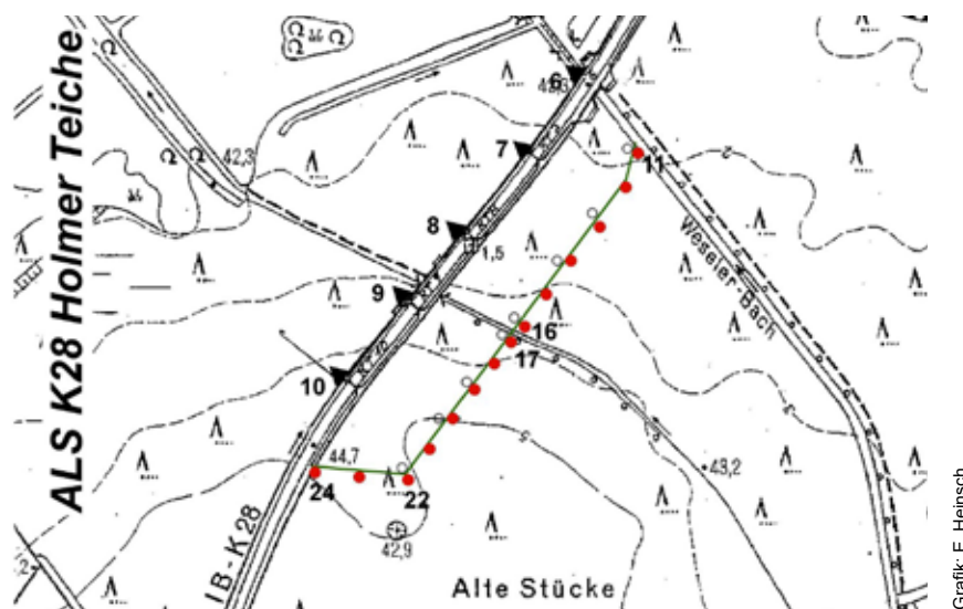
Abb. 1: Lage des Zaunes sowie die Nummerierung der eingesetzten Fang-eimer am Amphibienleitsystem an den Holmer Teichen
