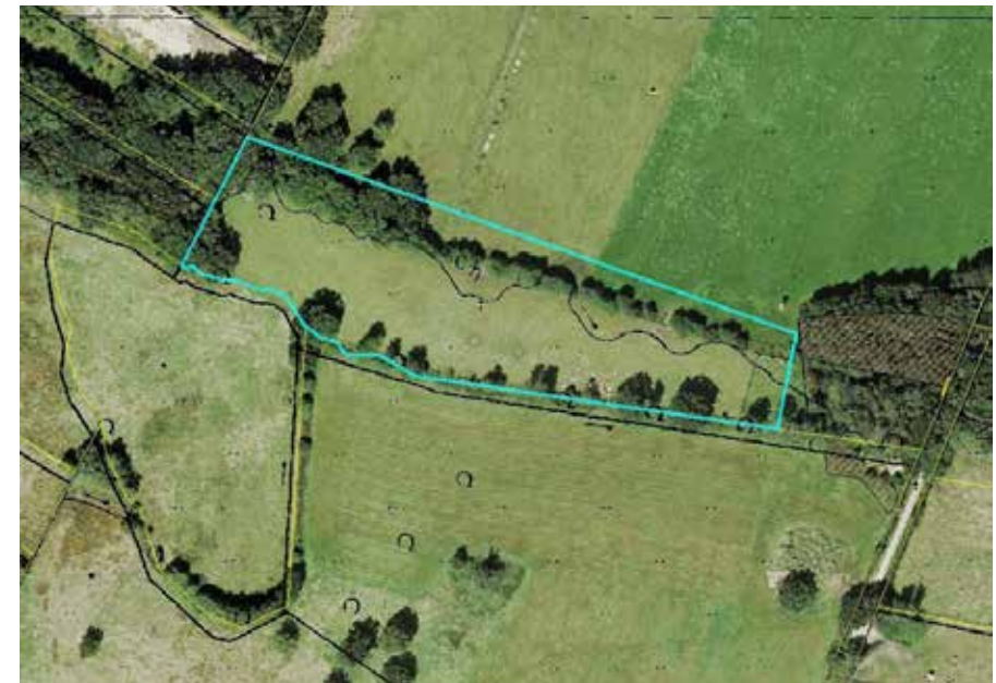
Der Bachlauf in dem blau markierten Grundstück läuft jetzt geradlinig dort, wo sich am Nordrand die Erlenreihe befindet. Die schwarze Schlingelinie markiert den ehemaligen Verlauf des Heidbaches. Ziel der Restrukturierungsmaßnahme ist, den Bach wieder in den natürlichen Verlauf zu bekommen.
