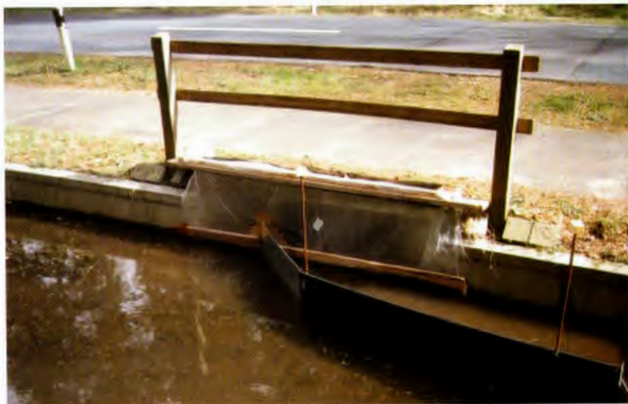
Mit Folie abgehangter Tunnel 7 (vgl. Text), im Vordergrund die Zuleitung zum Fangeimer; mittig im Tunnel hängt ein Temperatur-/Feuchtkeits-Datalogger
